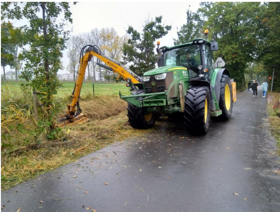
Figuur 18. Klepelmaaier aan het werk langs de Hoofddijk.
